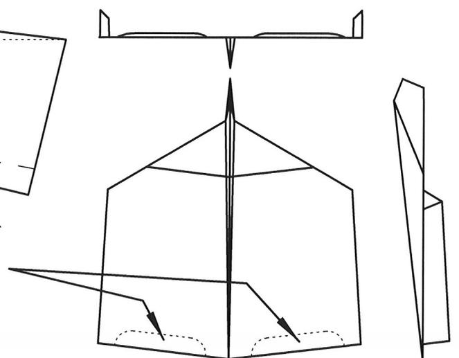
Zum Trimmen die Hinterkante der Flügel leicht nach oben wölben.
